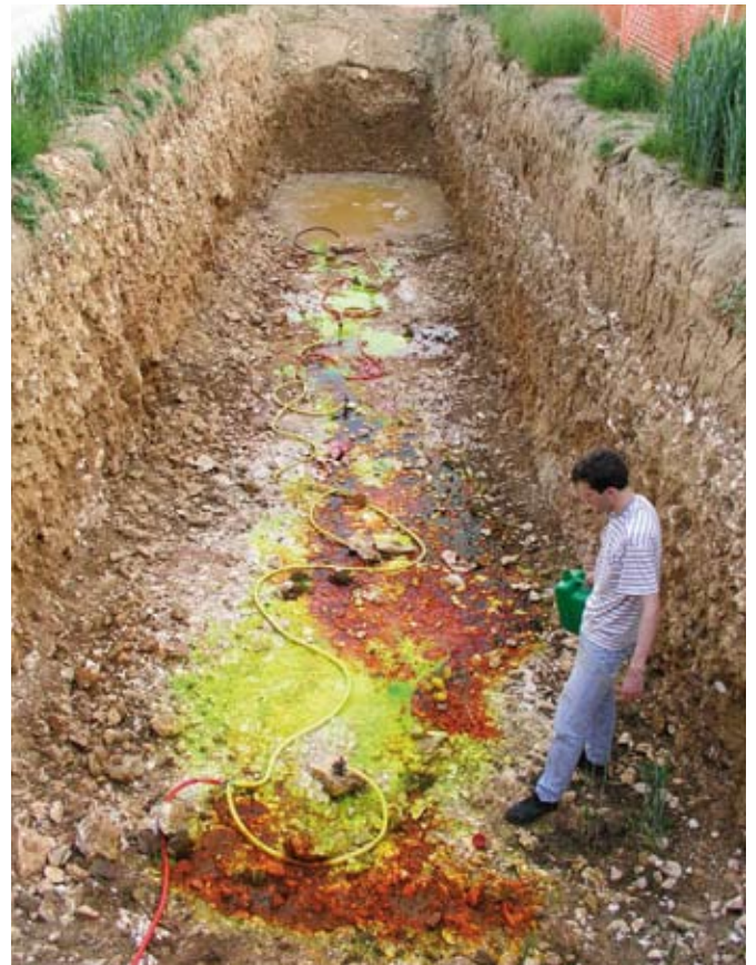
Abklärung der Grundwasserverhältnisse mit Markierstoffen in einem Karstgebiet.
