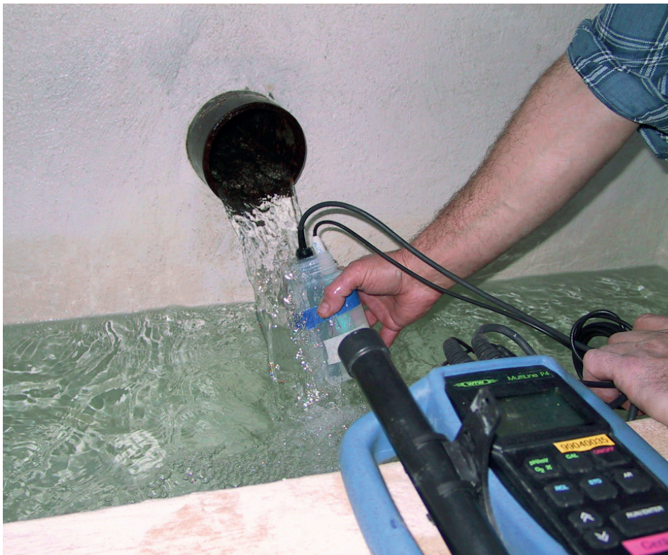
Probenahme in einer Brunnenstube: moderne Messgeräte für eine erste Beurteilung vor Ort
