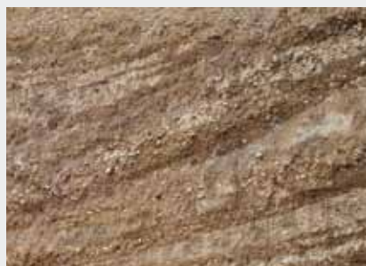
Lockergesteins-Grundwasserleiter: In den Poren von Kiesen und Sanden, meist Schotterablagerungen, zirkuliert Wasser.
