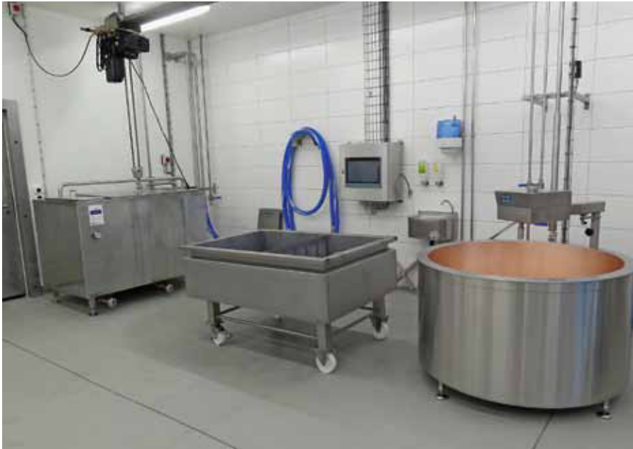
Das 600-Liter Kessi dient der handwerklichen Käseherstellung in der neuen Schulkäserei am Standort Salez
