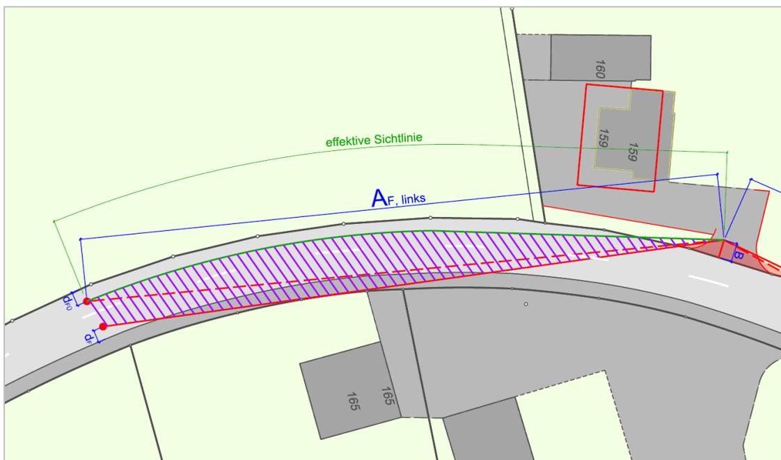
Abb. 5: Beispiel Korrekte Darstellung der Sichtzone im Kurvenbereich
